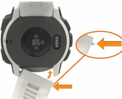
**POZNÁMKA:** Zkontrolujte, zda je řemínek rádně připevněn. Osička musí zacvaknout do příslušných otvorů na zařízení.
